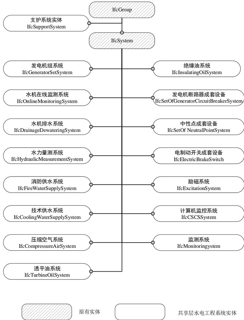
图3 共享层水电工程系统实体构成及与 IFC 原有实体关系图
